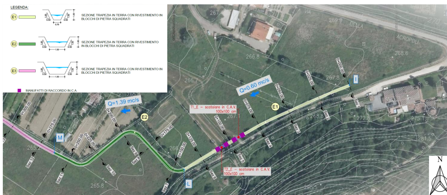
Figura 4-8: planimetria su fotomosaico del fosso Est (da progr. 0+000 a progr. 0+300). Estratto elaborato T-06.
