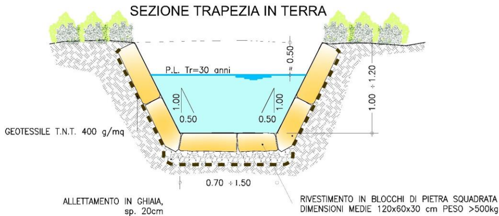
Figura 4-10: sezione tipo fosso Est. Estratto elaborato T-06.
