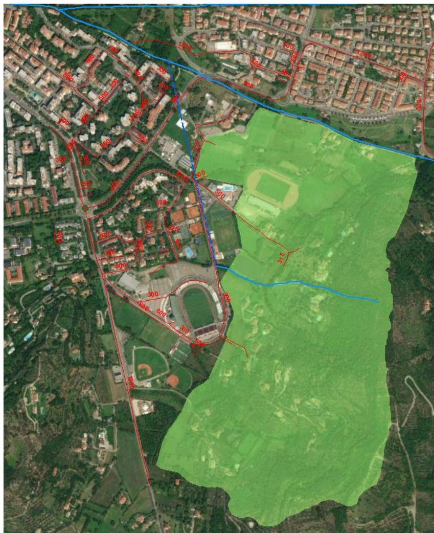
Figura 1-3: bacino idrografico che sarà intercettato e drenato dalle opere, di superficie pari a circa 75.5 ha, che sarà quindi sottratto, nella configurazione di stato di progetto, al sistema fognario cittadino.
