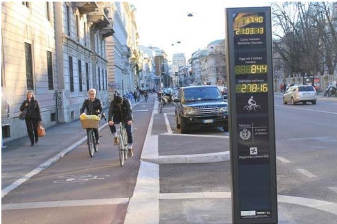
In **n. 4** sezioni della rete ciclabile ritenute maggiormente significative saranno inoltre installati **contatori automatici dei passaggi di biciclette** che saranno utili per effettuare il monitoraggio dei risultati. Un contatore sarà dotato di totem visualizzatore dei passaggi rilevati di biciclette (ecocontatore) e sarà installato su uno dei tratti maggiormente significativi.
