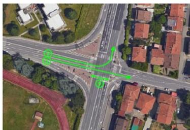
Figura 2: Intersezione via Fiorentina-Tangenziale: stato attuale - fase 2 impianto semaforico
